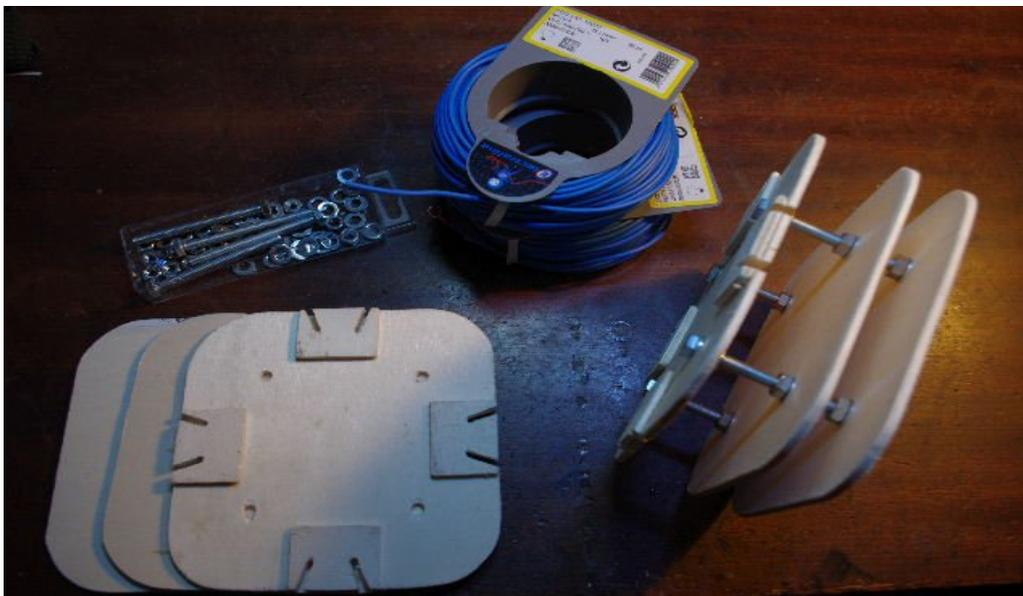
Il materiale con cui viene realizzato l'avvolgitore può essere indifferentemente legno (compensato da almeno 6 mm. successivamente trattato con flatting) oppure plexiglass (del tipo per UV) di spessore di almeno 6 mm.
