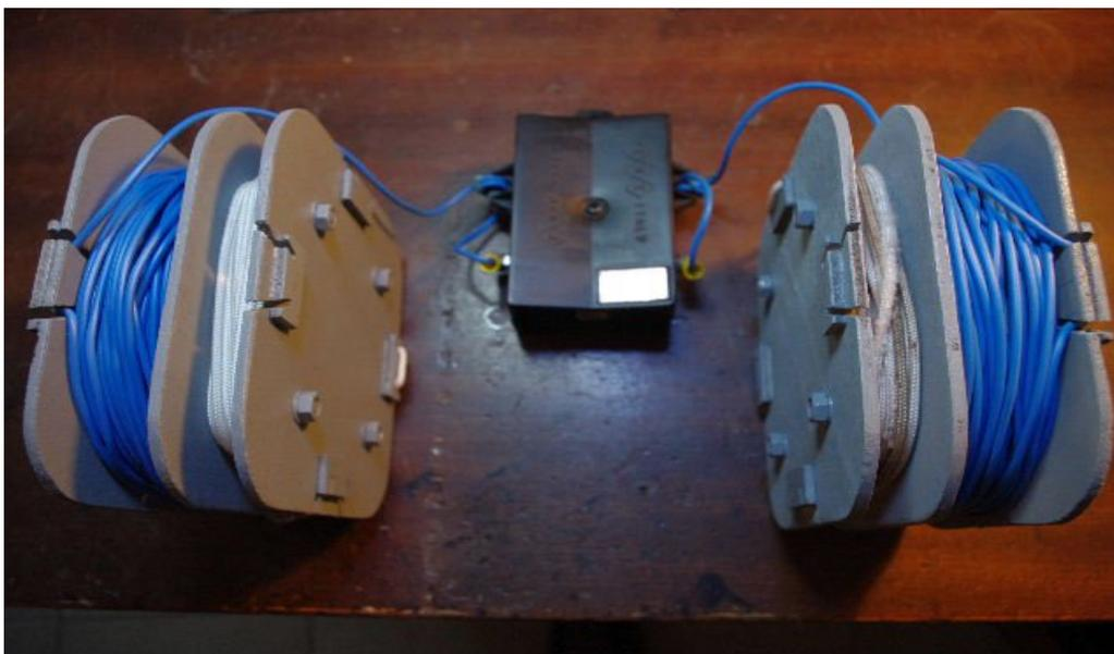
Dalle foto si può anche notare il sistema di blocco alla lunghezza desiderata sia del filo elettrico sia dei tiranti di nylon, sistema di blocco semplice, immediato e autosufficiente: esso non consente regolazioni al cm. ma con una tolleranza di 5-8 cm la quale però - specie sulle bande basse - risulta del tutto accettabile e talvolta ininfluente.
